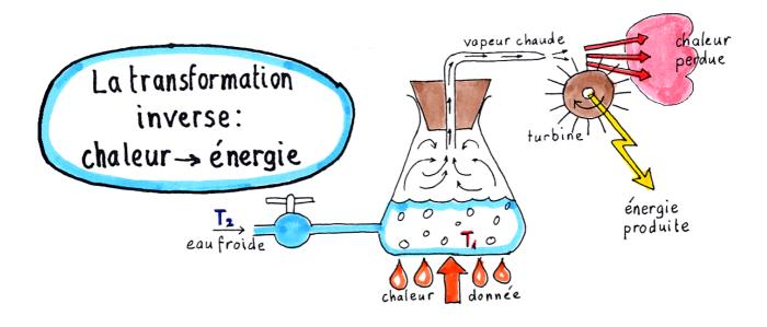
La transformation inverse de la chaleur en énergie est possible, même artificiellement, à l'aide des machines thermiques (centrales thermo-électriques, machines à vapeur, moteurs à combustion de toutes sortes).
