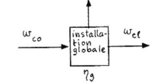
La chaîne des rendements d'une centrale thermique
